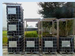
Biofilter voor zuivering reinigingswater Vergoeding: 750 euro
